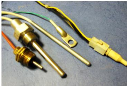
Рисунок 1.3 - Приклади зовнішнього виконання терморезистивних датчиків. Із роботи [2]
